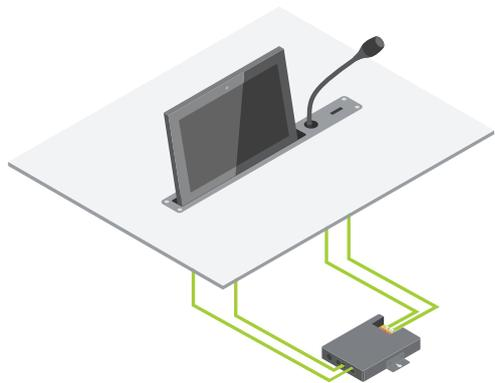
Configurazione di uniBOX con schermo motorizzato
