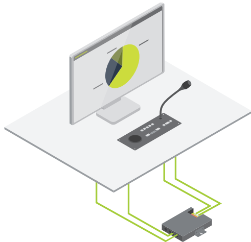
uniBOX PRO con una pantalla de sobremesa y una unidad empotrable con los módulos Confidea que se deseen
