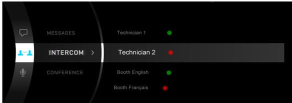
Die Intercom-Funktion ermöglicht es ausgewählten Teilnehmern, miteinander zu kommunizieren, ohne dass andere Geräte erforderlich sind. Sie ermöglicht auch die Kommunikation an Orten, an denen eine visuelle Verbindung zwischen den Teilnehmern fehlt: beispielsweise in einer Dolmetscherkabine, die sich nicht im eigentlichen Sitzungsraum befindet.
