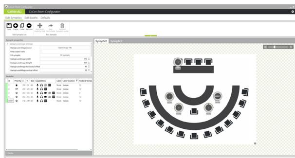
Room Configurator est utilisé pour créer et modifier le plan synoptique de la salle. Un plan synoptique est une représentation visuelle de l'agencement de la salle de conférence. Il peut comprendre des microphones, une image de fond et plus encore.
